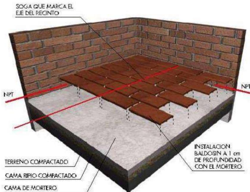
Una vez establecida la dirección de las canterías, según el diseño del proyecto, se procede a la colocación de la capa de mortero de 5 [cm] de espesor. Se recomienda que el avance longitudinal de la colocación de ésta capa sea equivalente a 5 hileras de Baldosín, lo cual hace más fácil la instalación y nivelación del Baldosín por parte del instalador.
