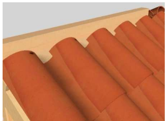
Instalación de quilla de madera.
