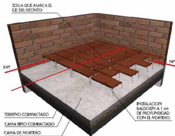
AXONOMETRICA COLOCACION BALDOSIN
