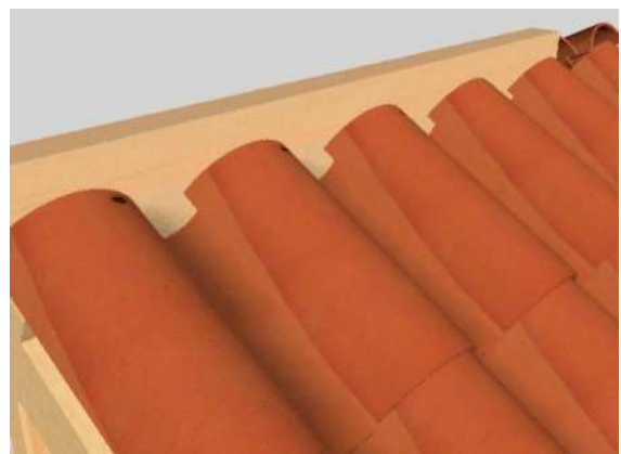
Instalación de quilla de madera.
